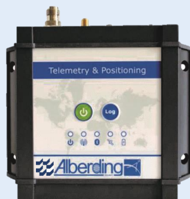
Bild 3: Im Projekt entwickelter Datenrouter mit RTK-GPS, UMTS, Bluetooth und LINUX zur On board Datenplausibilitätskontrolle
