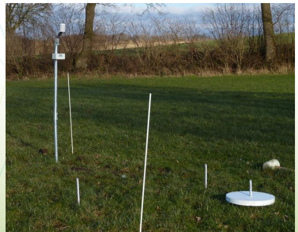
Abb. 6: Messung des Längenwachstums mithilfe einer Styroporplatte und fest installierten Messskalen
