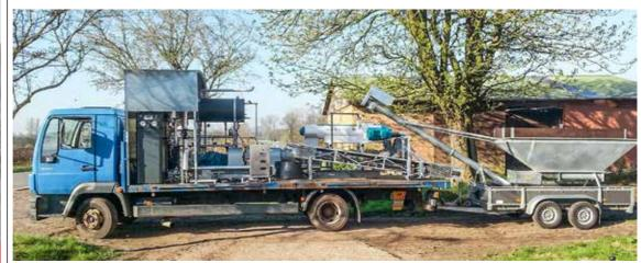
Die im EIP-Projekt entwickelte mobile Expanderanlage, um den Futterwert durch Aufschluss der Nährstoffe aus der Ackerbohne zu steigern.
